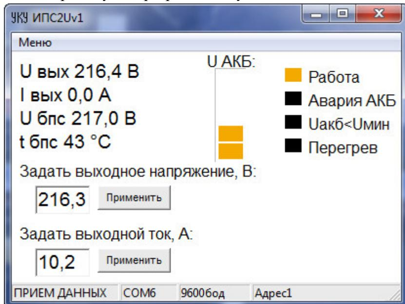
Программа отображает выходные параметры ИПС, температуру радиатора, уровень напряжения на батареи.
